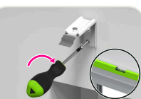
Plafond Steunen tegen het plafond, ook in de raamopening.
